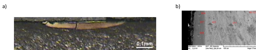
Rys. 13. Fragment warstwy wierzchniej pod powierzchnią toczną z widoczną warstwą białą: a) obraz z mikroskopu optycznego, b) obraz skaningowy z mikroskopu elektronowego (SEM)
