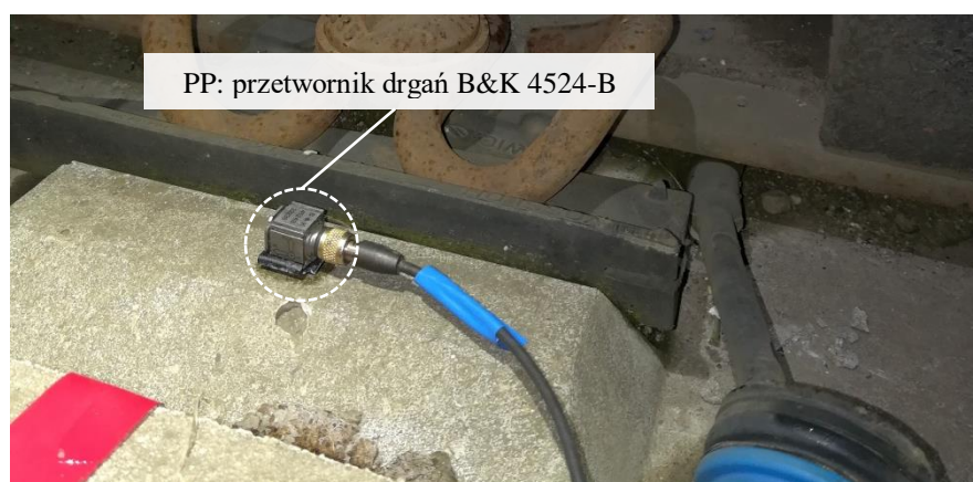
Rys. 7.14. Widok przetwornika drgań B&K 4524-B w punkcie pomiarowym PP
