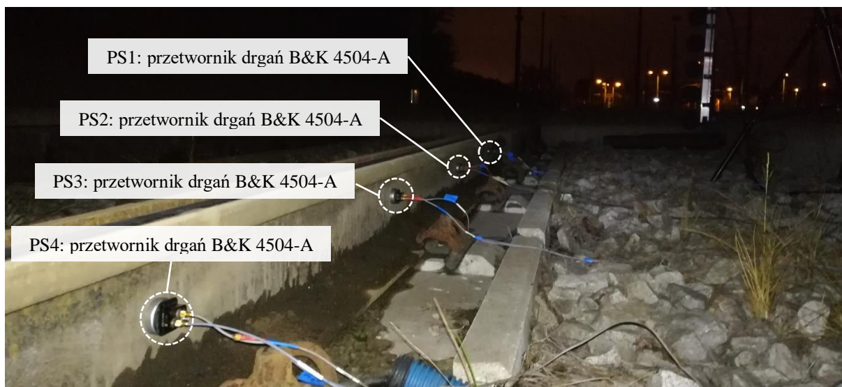
Rys. 7.13. Widok przetworników drgań B&K 4504-A w punktach pomiarowych PS1–4
