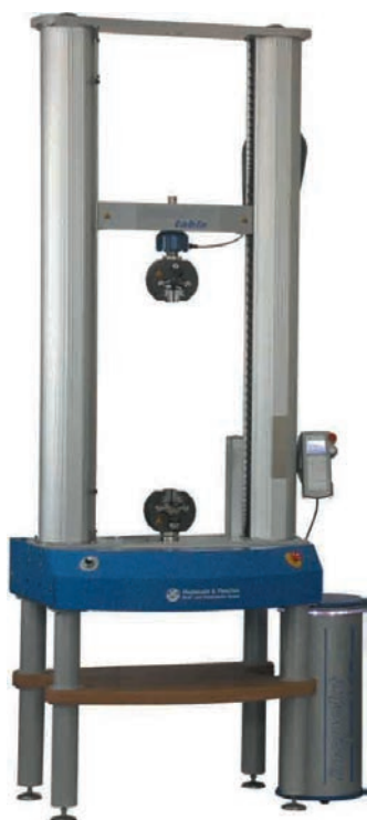
Rys. 3. Maszyna wytrzymałościowa Inspekt table 50 kN do wzorcowania urządzeń technologicznych (np. dynamometrów) w siedzibie Klienta lub w laboratorium ITA
