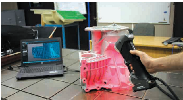
Rys. 4. Ręczny skaner laserowy HandySCAN 700 podczas skanowania odlewu [6]
